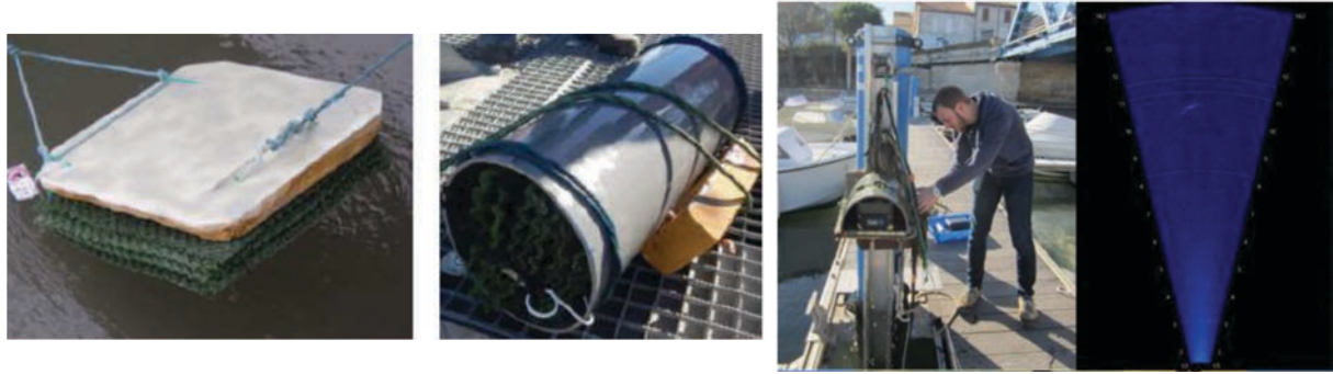
Figure 23 : Flottangs (à gauche) et caméra acoustique (à droite) installés dans le Grau de la lagune de Bages Sigean (source Université de Perpignan)
